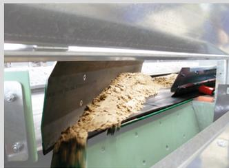
\* Die Schwertspitze teilt den Materialstrom ohne Bugwelle. Gleitflächen sind beschichtet. Schächte und Abdeckungen zur Staubabsaugung sind aufklappbar.
