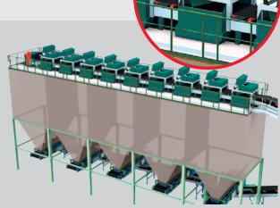
Llenado de silo mediante un escalonamiento de rascadores en V para premezclado de arena de fundición.
