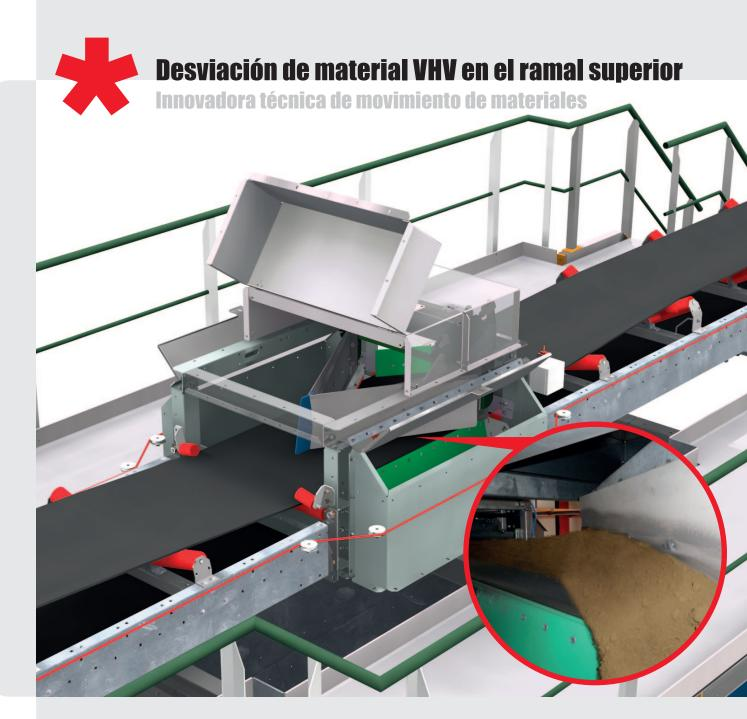
Rascador VHV en forma de V para desviación lateral de material.
