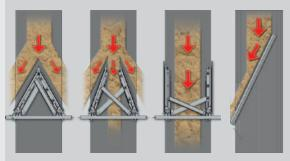
★ Variantes de ajuste para esclusado de material, también ajustable en anchura mediante motor eléctrico.
