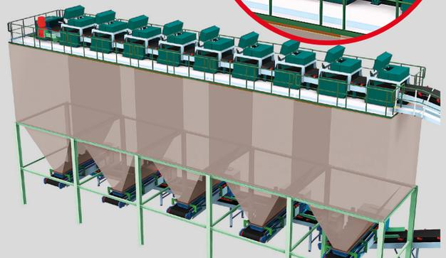
\* Remplissage de silo par positionnement du soc pour obtention de prémélange sur sable de fonderie.
