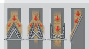
\* Varianti di regolazioni per lo scarico di materiale, regolabile anche in ampiezza con motore elettrico.
