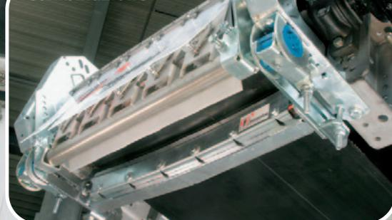
Raschiatori a torsione con lame a metallo duro
