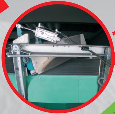
\* Abstreiferpflug aufklappbar und / oder weitenverstellbar zur Sandverteilung auf die Bunker
