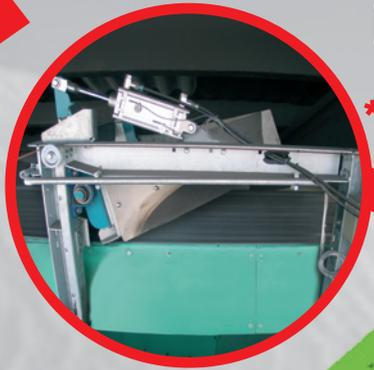
\* Rascador abatible de descarga en V y/o regulable en anchura para distribución de la arena en los silos
