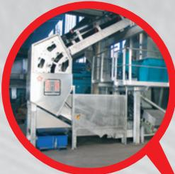
\* Pulmón para arena preparada con cinta transportadora de descarga
