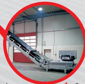
\* Convoyeur à bande de recouvrement avec bandes lisses incliné à 35 °
