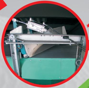
\* Raclor de déflexion rabattable et/ou réglable en largeur pour la répartition du sable dans les trémies
