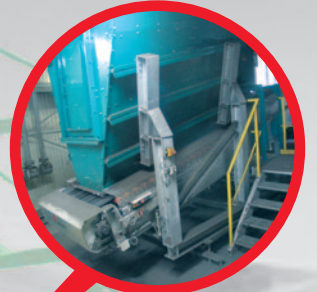
* 処理済み砂バッファータンクと切り出しコンベア
