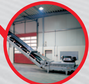
* フラットベルトを使用した傾斜角度35°のカバーベルトコンベア
