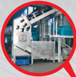
* カバーベルトコンベアと垂直バンドユニット
