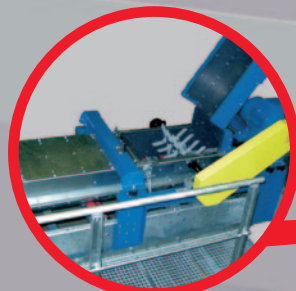
* 攪拌機、連続で流れる材料のダマを砕く
