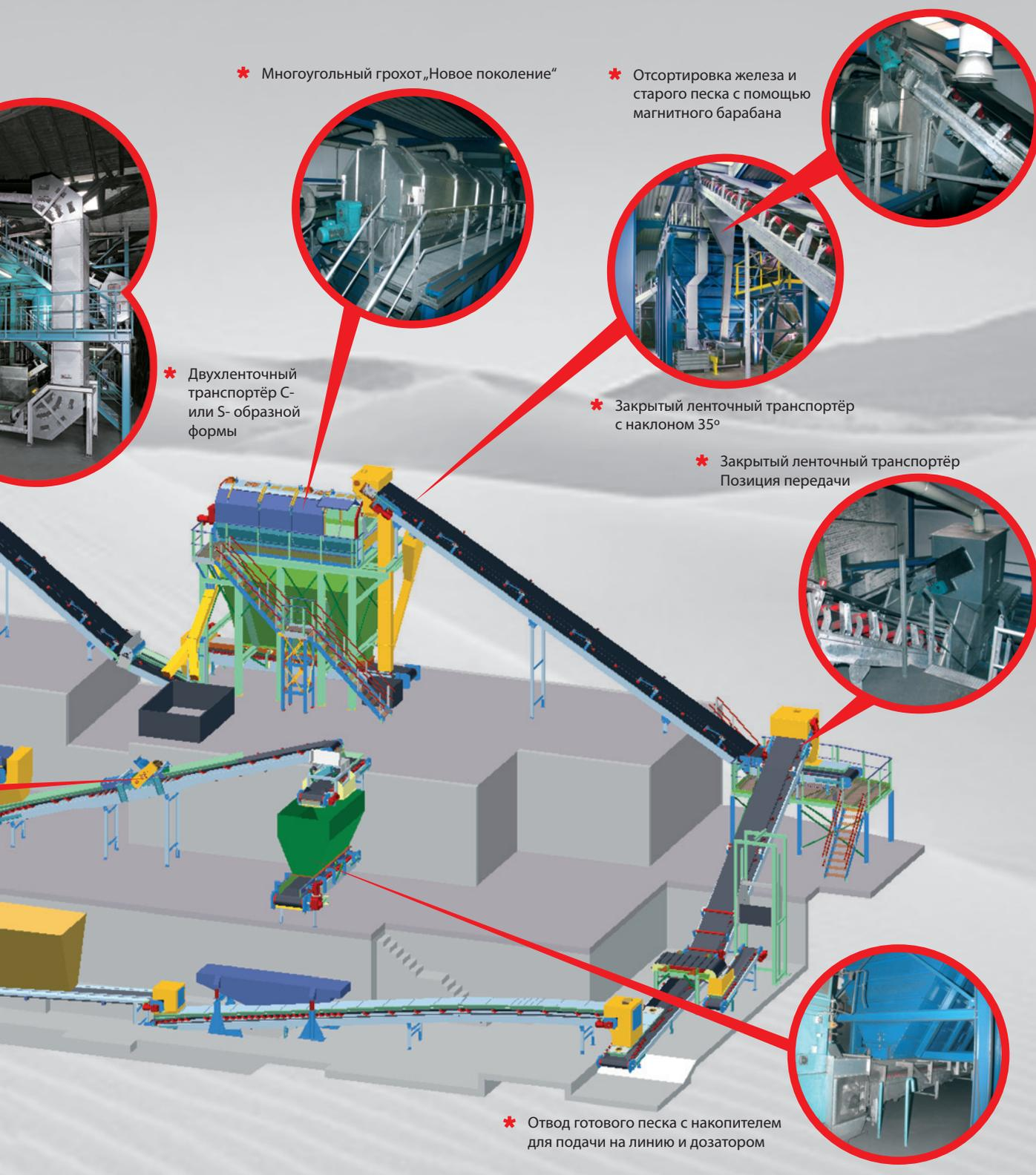
Наши системы совместимы с оборудованием ведущих изготовителей и позволяют бесппроблемную стыковку, даже в проблемных случаях. Благодаря модульной конструкции и накопленному опыту оборудование для подготовки песка как компактной так и крупногабаритной конструкции используется во всём мире.
