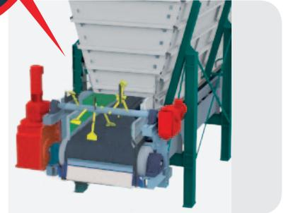
\* Alimentador por cajas para cargar con cargadores de rueda
