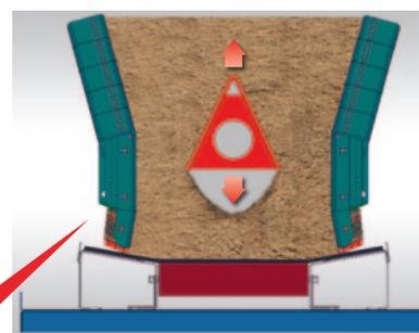
\* Уплотнения кромки конуса разгрузочного транспортёра без провисания (Вид в направлении транспортировки)
