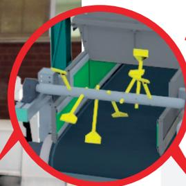
\* Бильный вал для дозирующей разгрузки
