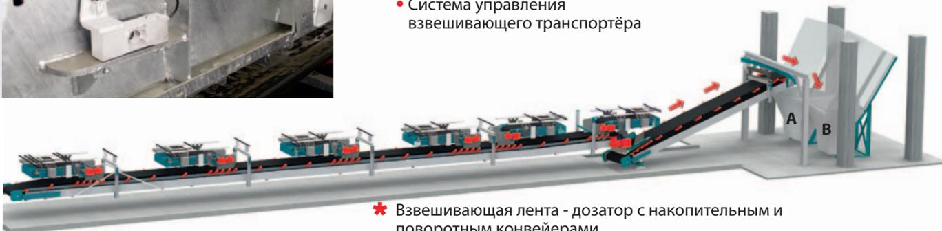
\* Взвешивающая лента - дозатор с накопительным и поворотным конвейерами
