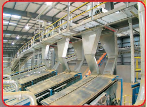
\* Beschickung der Siebmaschinen über Pflugabstreifer
