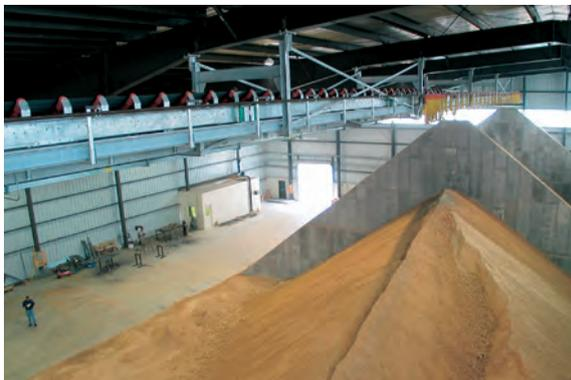
\* Tonlager mit fahr- und reversierbarem Gurtförderer
