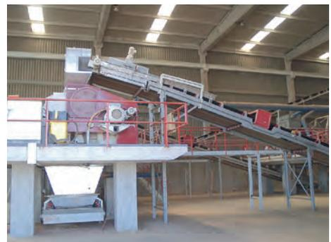
\* Aufklappbarer Gurtförderer mit Materialverteiler sowie Ein- und Auslaufschurre
