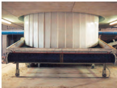
* Ancho de cinta hasta 5.200 mm en la parte inferior del molino de rulos
