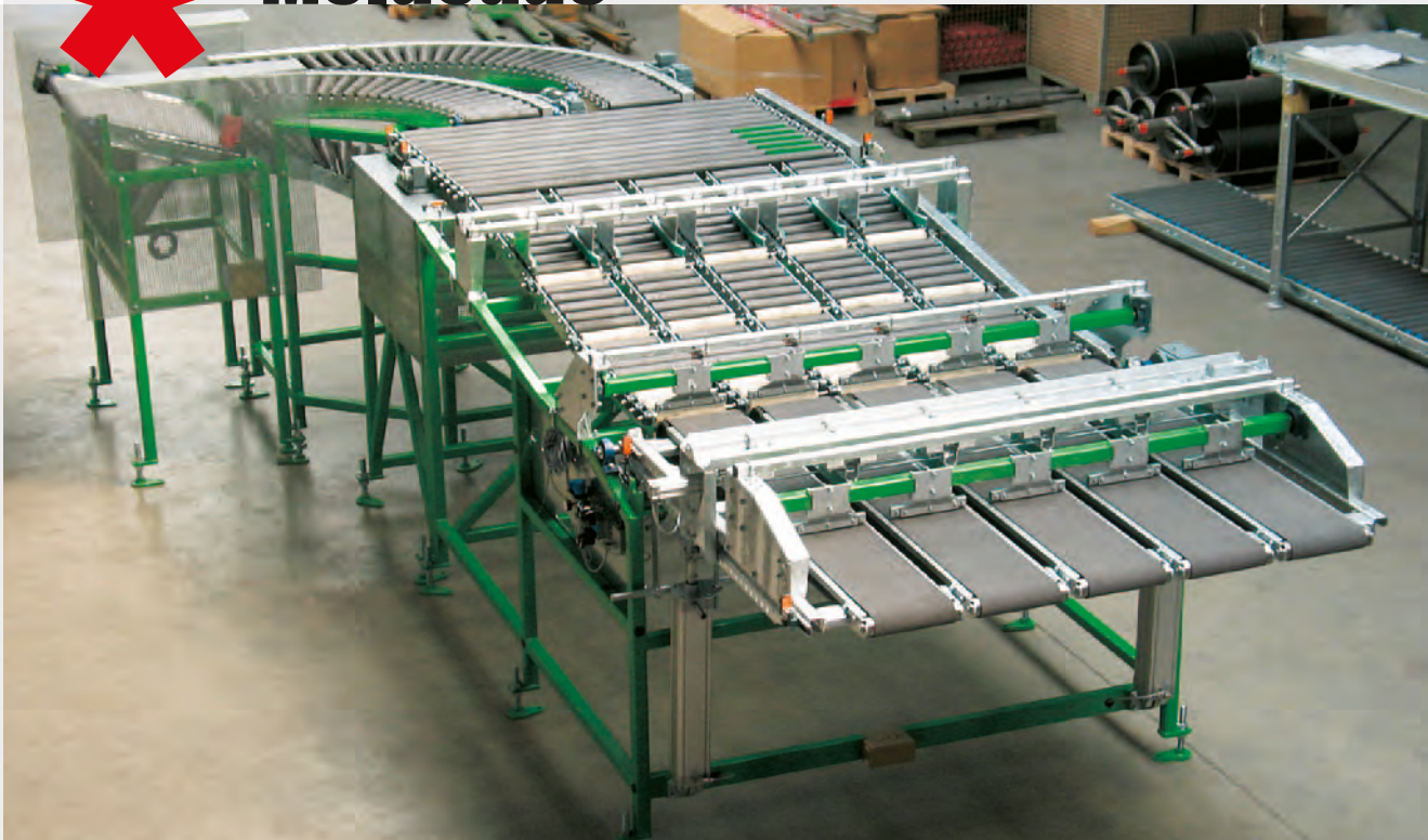
* Alimentación de galletas de barro con pulmón de estocaje y cintas de entrega plegables
