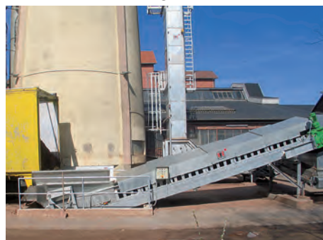
* Reprise par bande lors de déchargement par camion, LC 2000 mm
