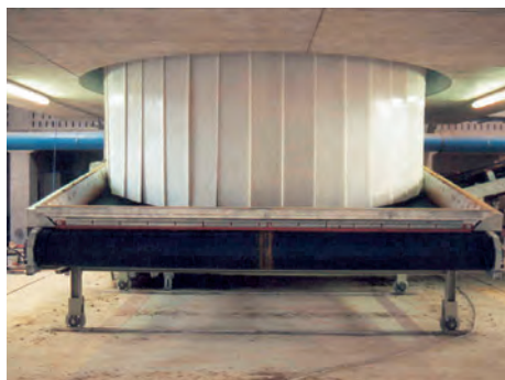
* Bande de 5200 mm de large sous meule
