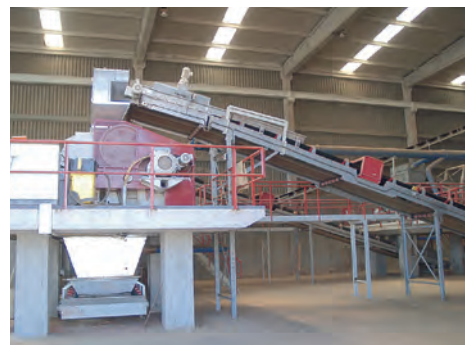
* Bande relevable avec répartiteur de matière avec goulotte entrée et sortie
