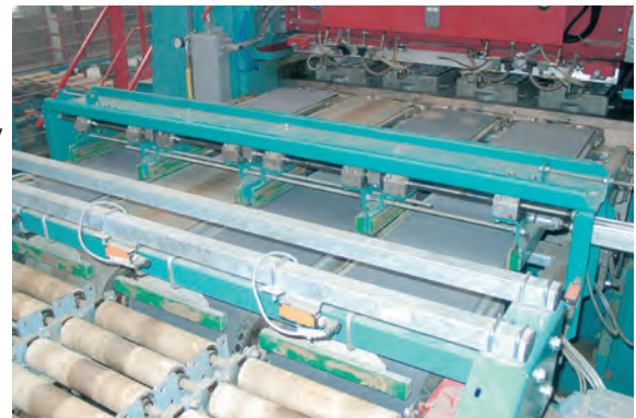
* Rail de guidage des galettes et centrage des galettes
