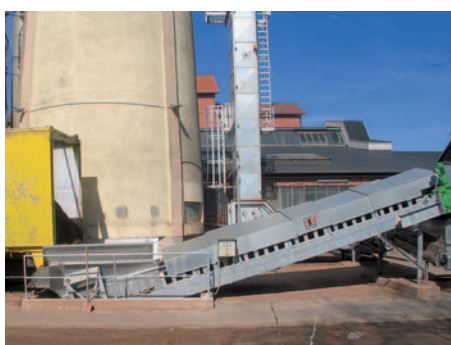
* Nastro trasportatore allo scarico del materiale. Larghezza tappeto 2000mm
