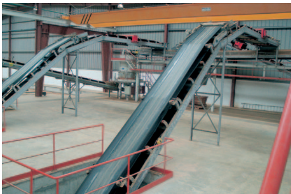
* Trasporto dei rifiuti con un nastro trasportatore a tappeti sovrapposti
