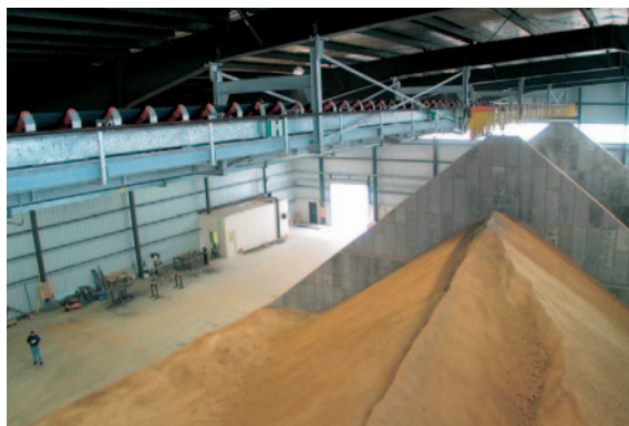
* Deposito di argilla con nastri trasportatori motorizzati e reversibili
