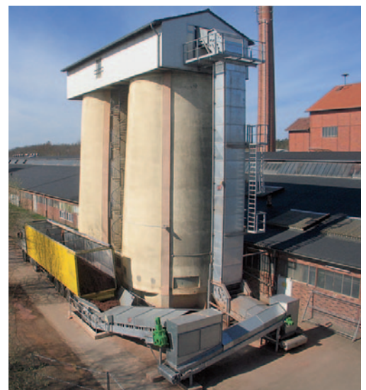
* Riempimento dei silo di stoccaggio argilla con un nastro trasportatore verticale
