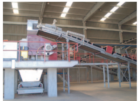
* Nastro trasportatore apribile con distributore del materiale e dotato di scivolo di entrata e di uscita
