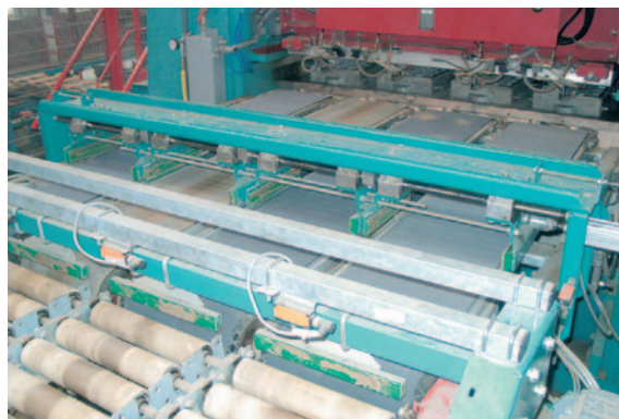
* Nastro trasportatore con bloccaggio dei mattoni e loro centraggio sul nastro.
