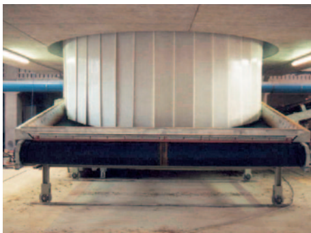
* Al di sotto del frantumatore il tappeto ha una larghezza fino a 5'200 mm
