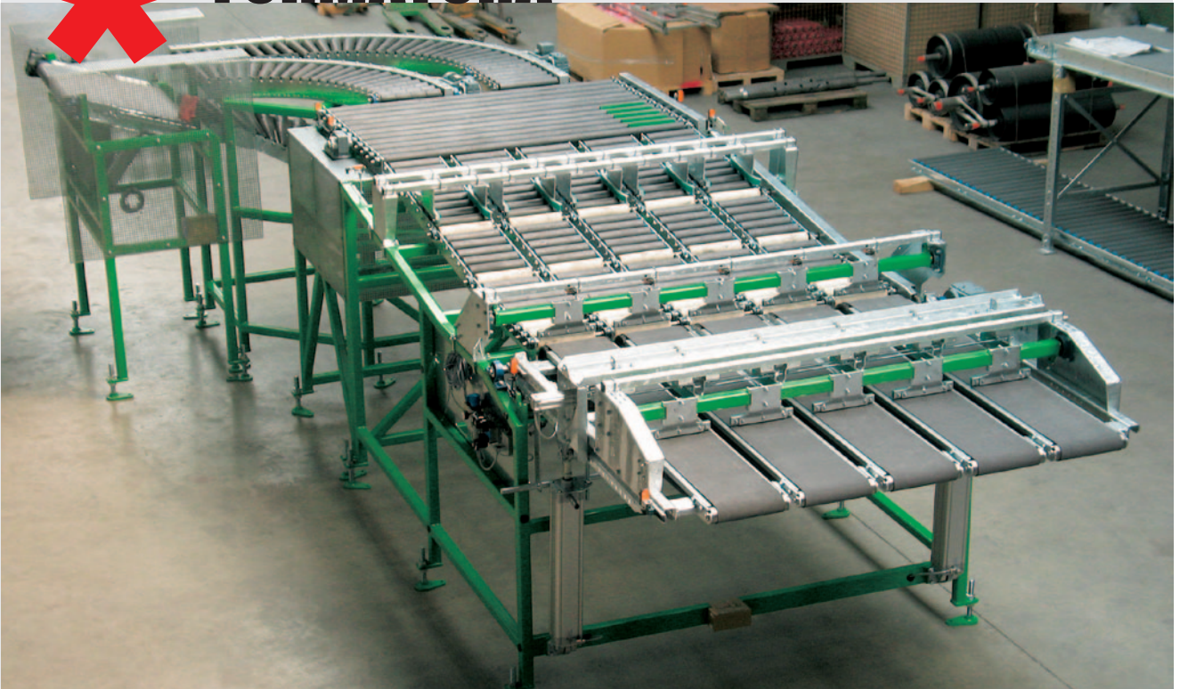
* Nastro trasportatore che convoglia i mattoni, con dispositivo di allineamento.
