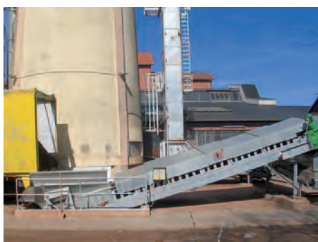
✳ トラックから材料を受け入れるため、ベルト幅2000mmも可能
