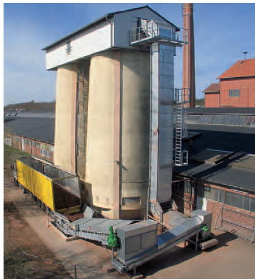
* サイロとダブルベルトコンベア
