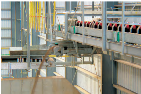
* Участок ленточного транспортёра с изменяемой скоростью
