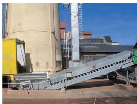
* Ленточные транспортёры для приёма груза с грузовиков, ширина ленты 2000 мм
