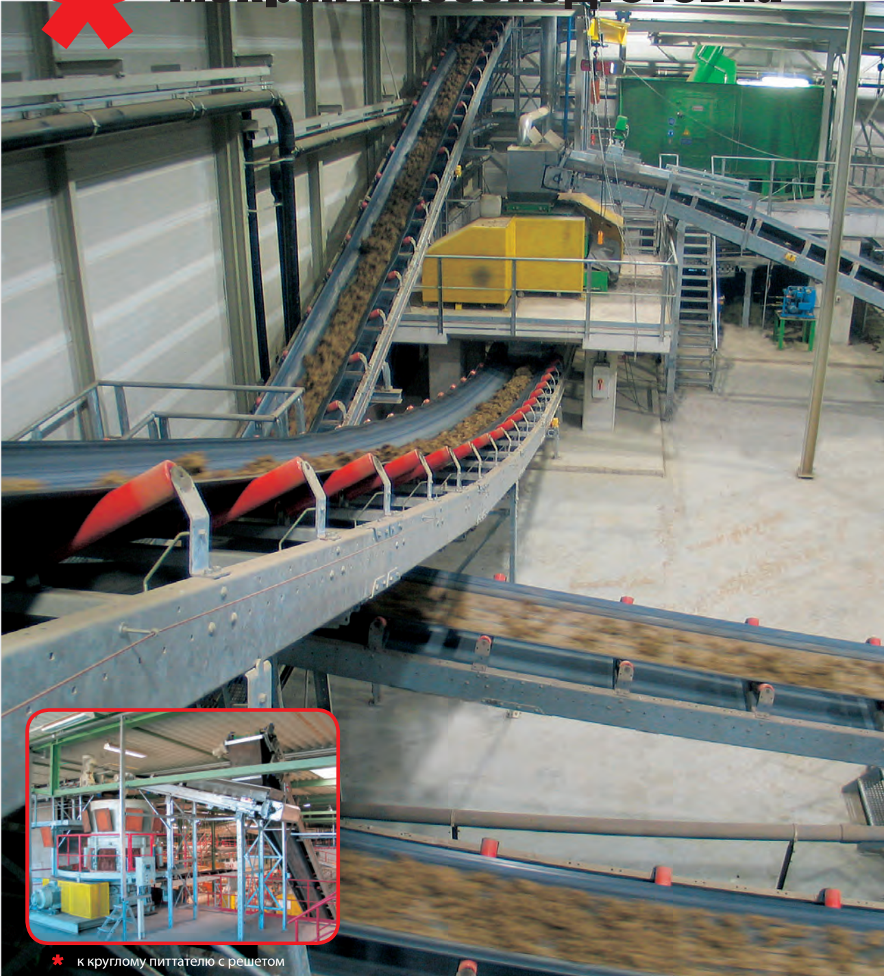
* Транспортировка к бегунам, дробилкам для измельчения и смешивания
