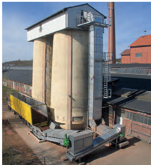
* Заполнение глинозапасника с помощью двойного ленточного транспортёра
