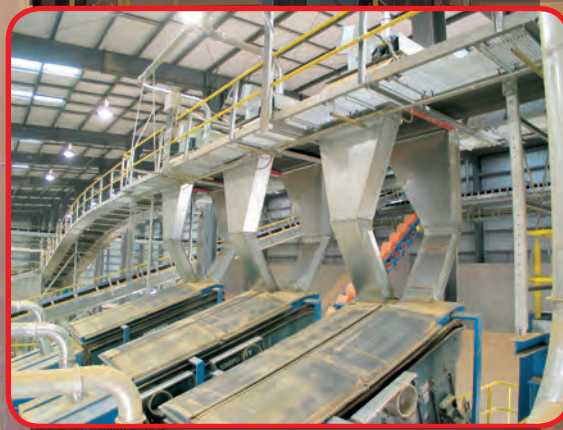
* Загрузка грохотов плужными скребками
