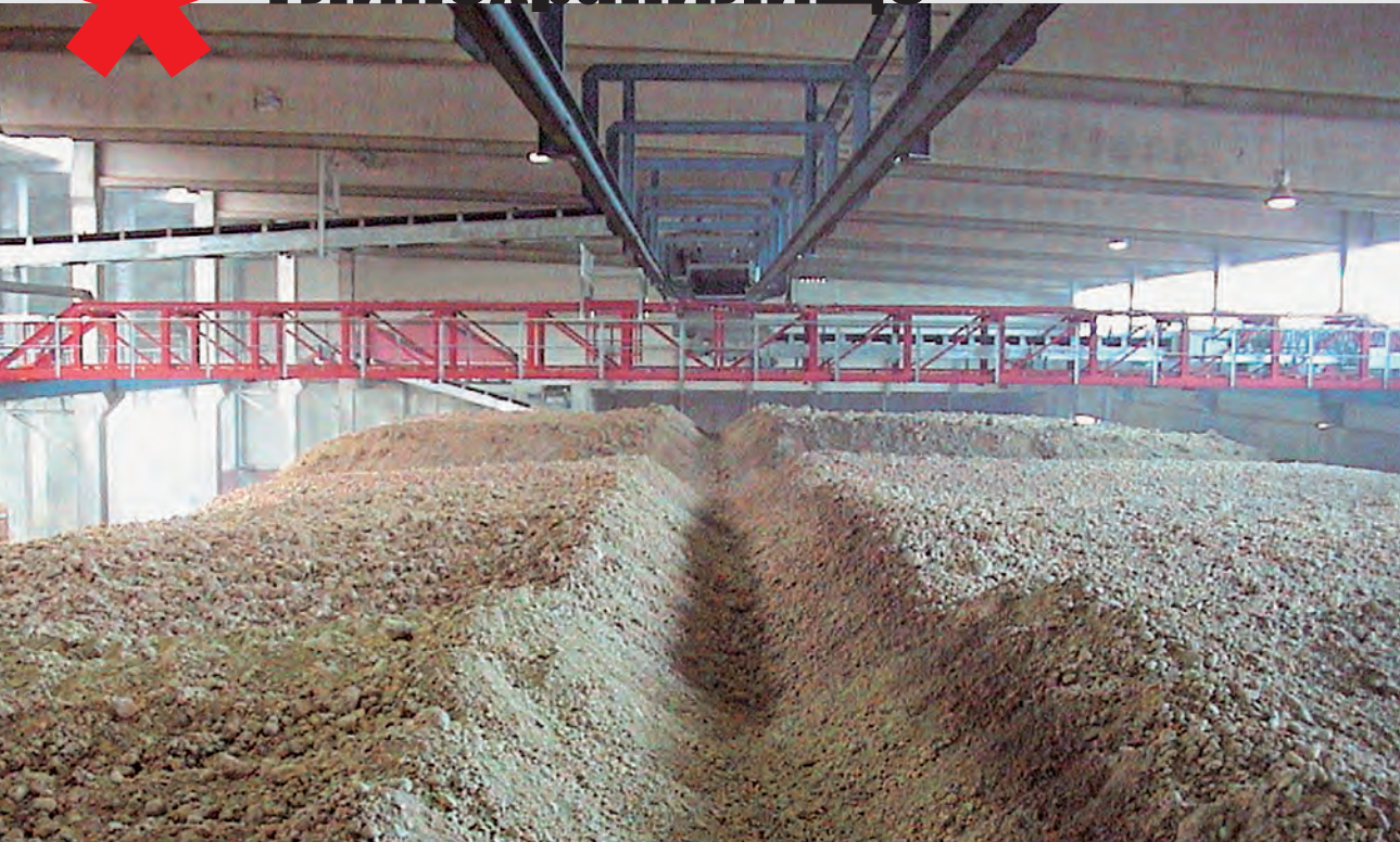
* Глинохранилище с загрузочной площадкой ленточного конвейера
