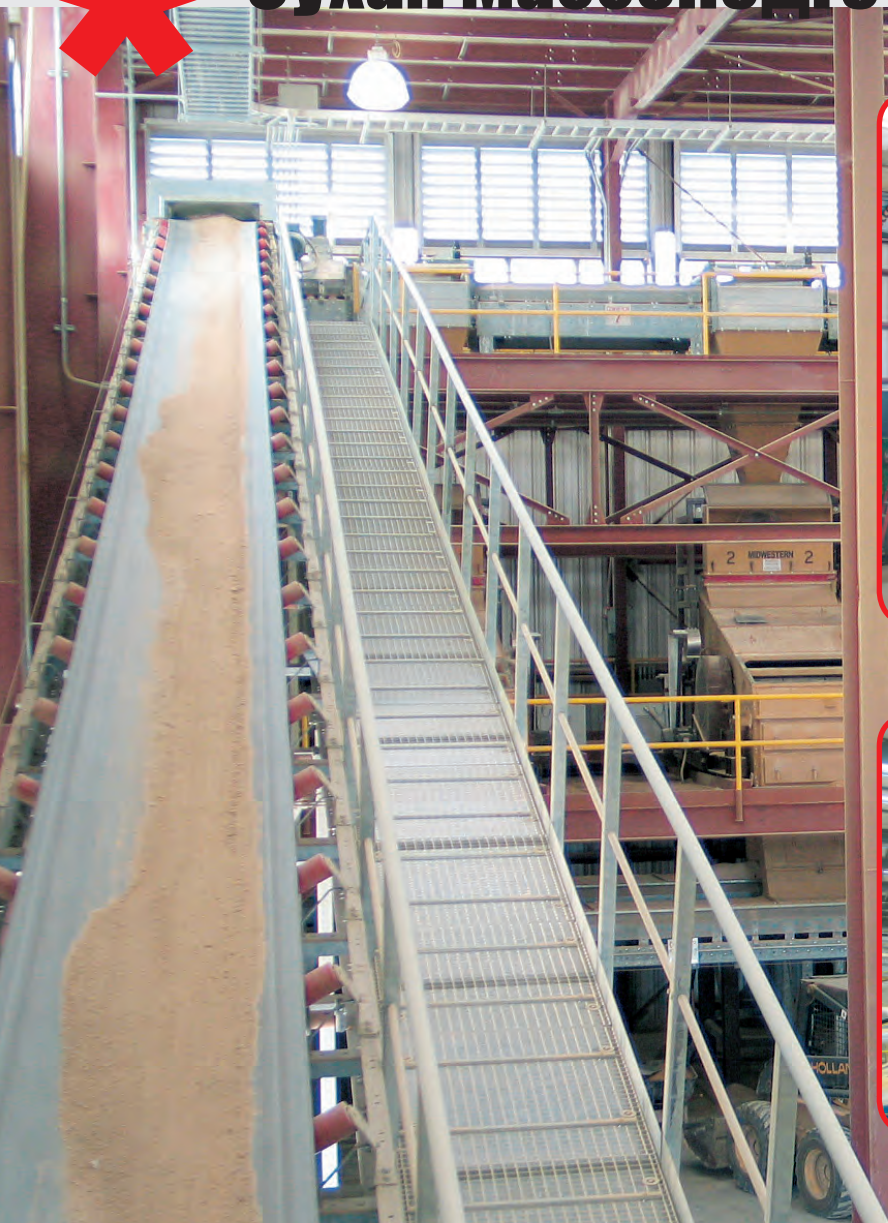
* От дробилки до механических грохотов
