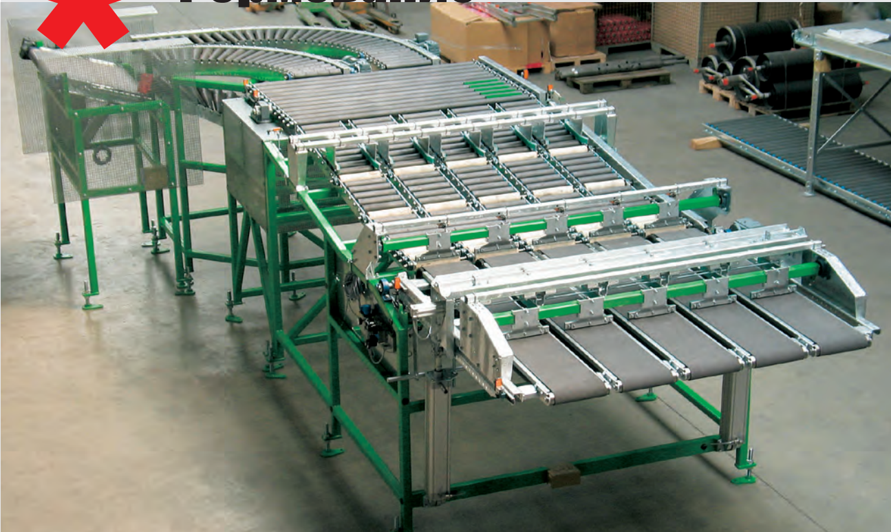
* Подача бруса с накопителем и откидными подающими транспортерами
