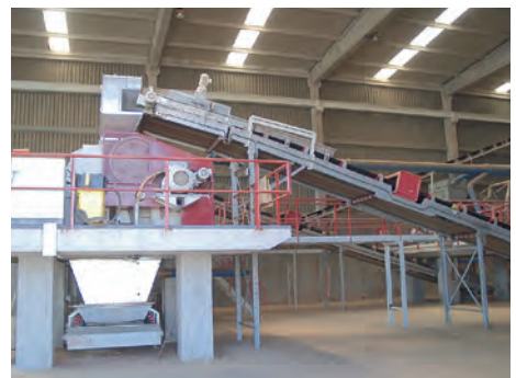
* Откидываемый транспортёр с распределителем материала, а также загрузочный и разгрузочный лоток
