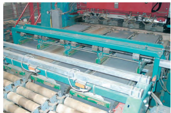
* Система блокировки и центрирование бруса
