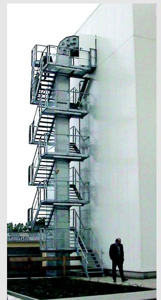
Convoyeur VHV à double bande verticale avec tour d'escaliers d'accès
