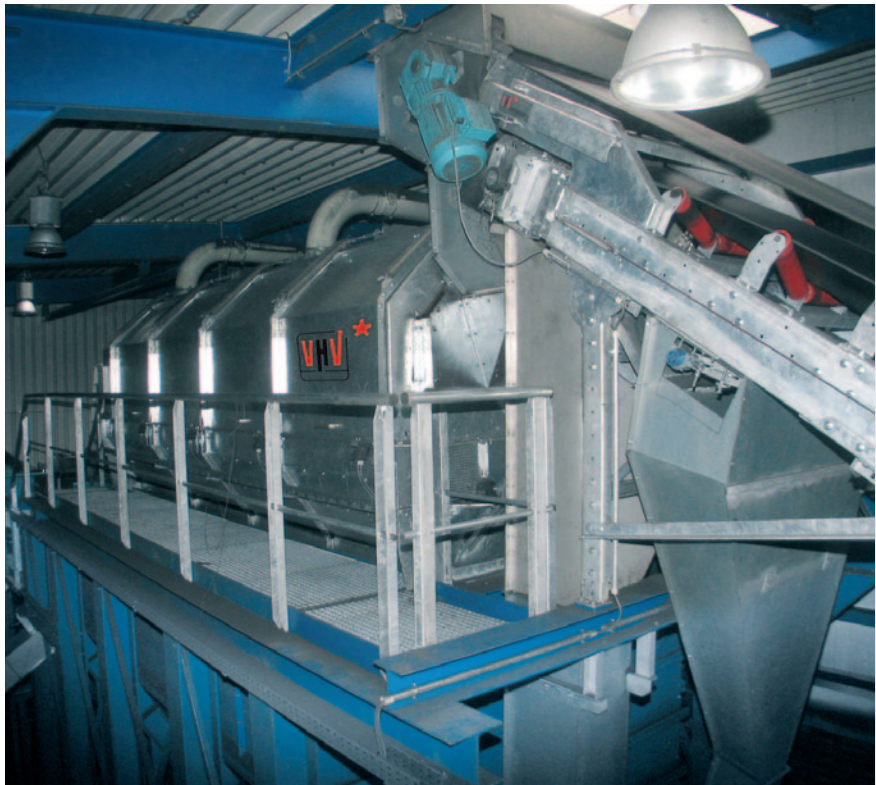
* Před polygonovým sítem je zařazen magnetický buben s odhazovací šachtou pro odlučení kovu a sypajícího se písku.
