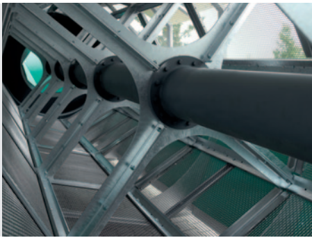
* kroucení odolné, skloněné tělo síta (vnitřní pohled)
