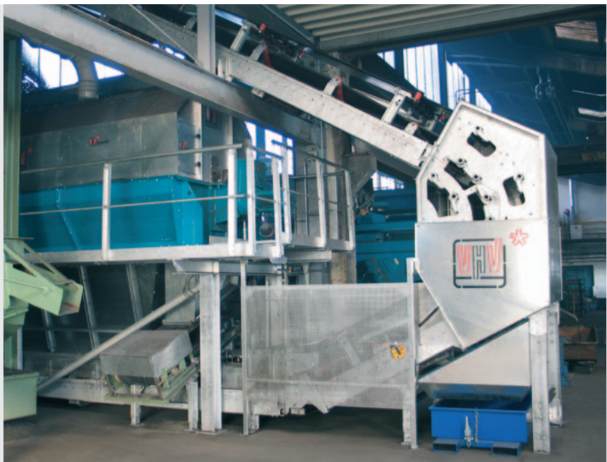
* Pásový dopravník VHV umožňuje umístění polygonového síta také v přízemí, nebo ve sklepe.
