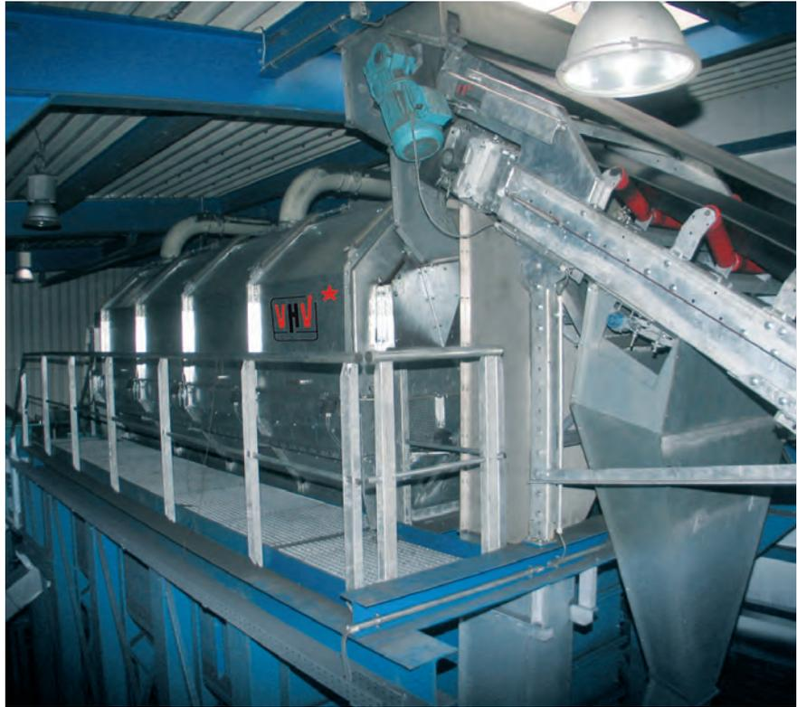
\* dem Polygonsieb vorgeschaltete Eisenausscheidung durch Magnettrommel mit Abwurfschächten für Eisen und Rieselsand.
