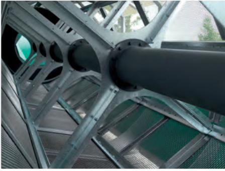
\* Criba inclinada resistente a la torsión (vista interior)
