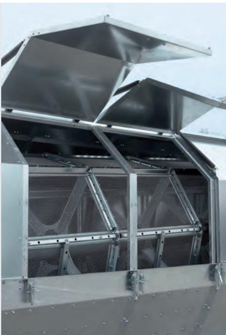
\* Maintenance aisée grâce à l'accès facile aux surfaces de tamisage toutes précontraintes et de construction identique.
