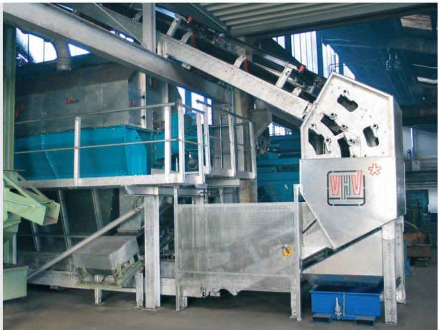
\* La hotte du convoyeur à bande VHV permet l'implantation de tamis polygonaux aussi bien au même niveau qu'en sous-sol
