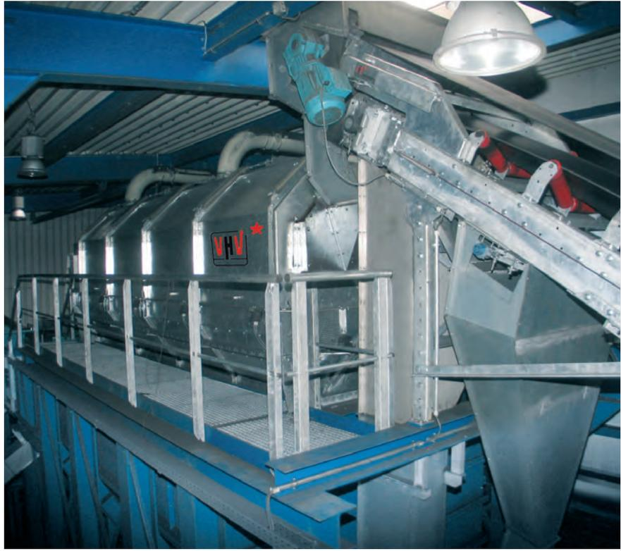
\* Élimination du fer par tambour magnétique avec bacs de récupération pour le fer et les fines de sable.
