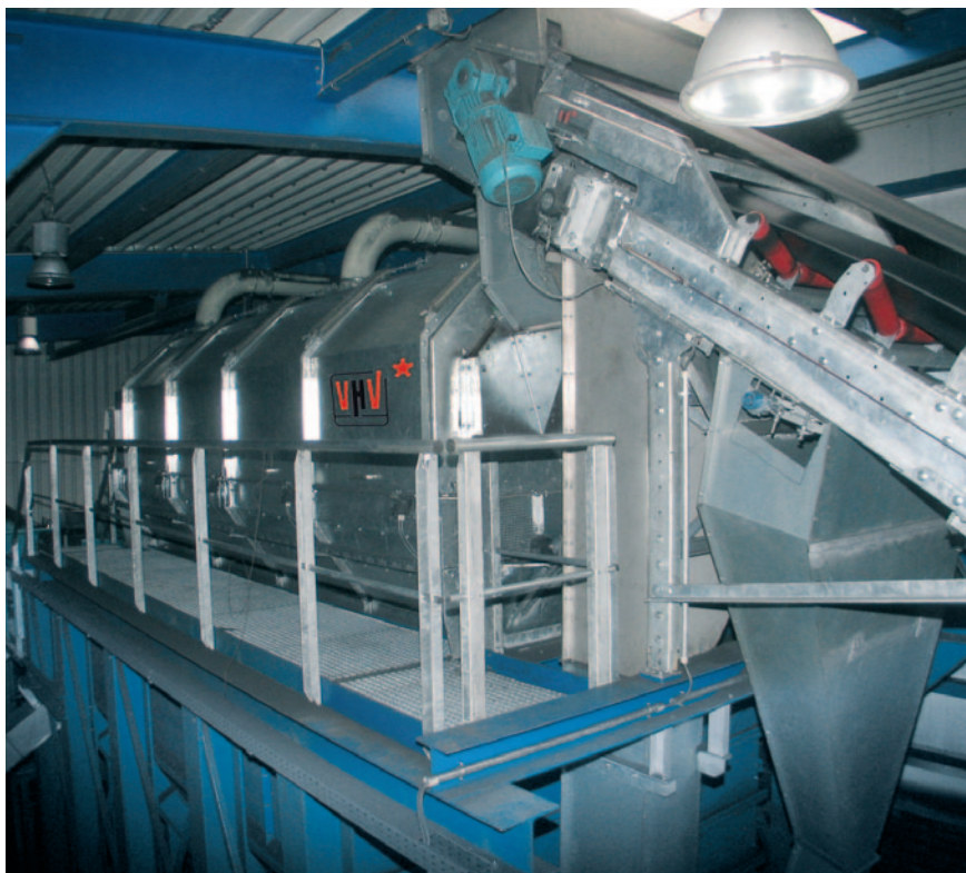
* deviazione e separazione ferro a monte del vaglio poligonale mediante tamburo magnetico con canale di caduta per ferro e sabbia
