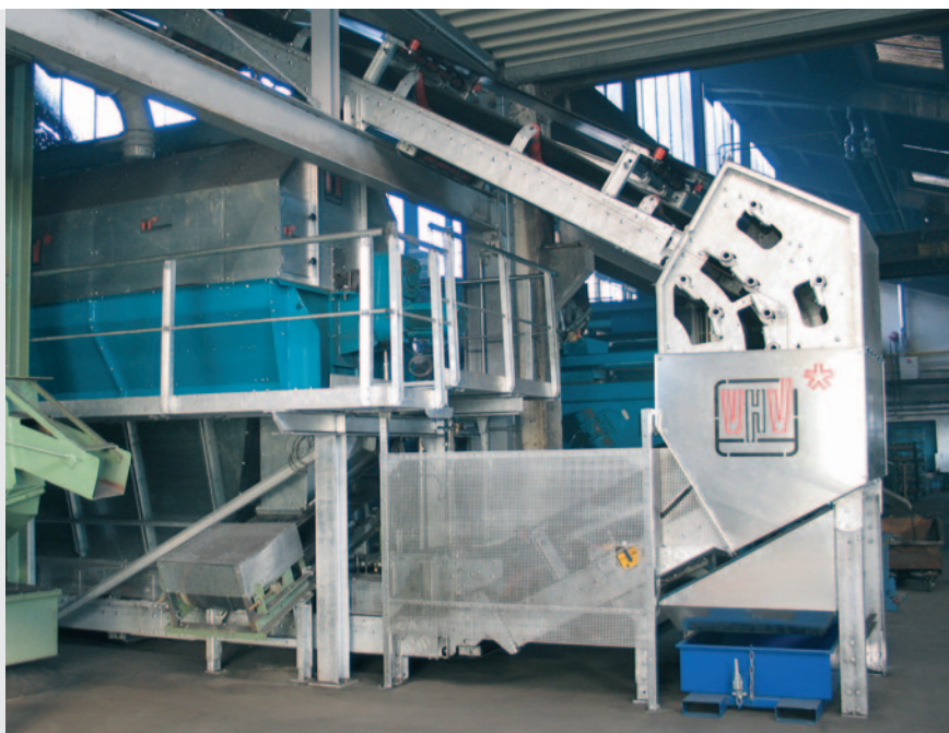
* L'estrazione del trasportatore a nastro VHV permette di montare il vaglio poligonale anche al piano terra o nei sotterranei.
