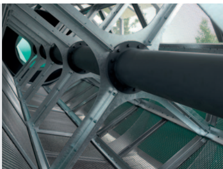
* corpi dei vagli inclinati, resistenti alla torsione (vista interna)
