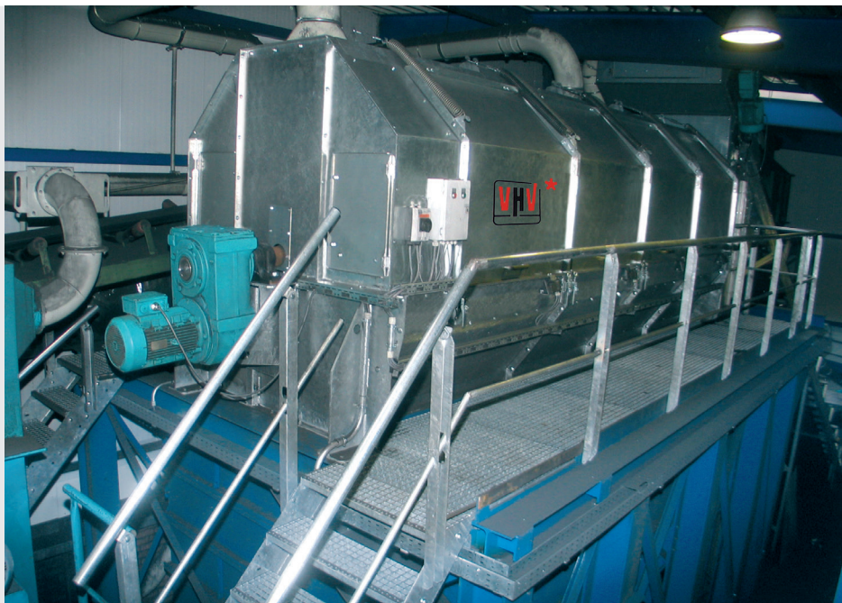
* 古砂ホッパーから直接砂を排出「調整可能な換気口、集塵及び放熱のための開口部」
