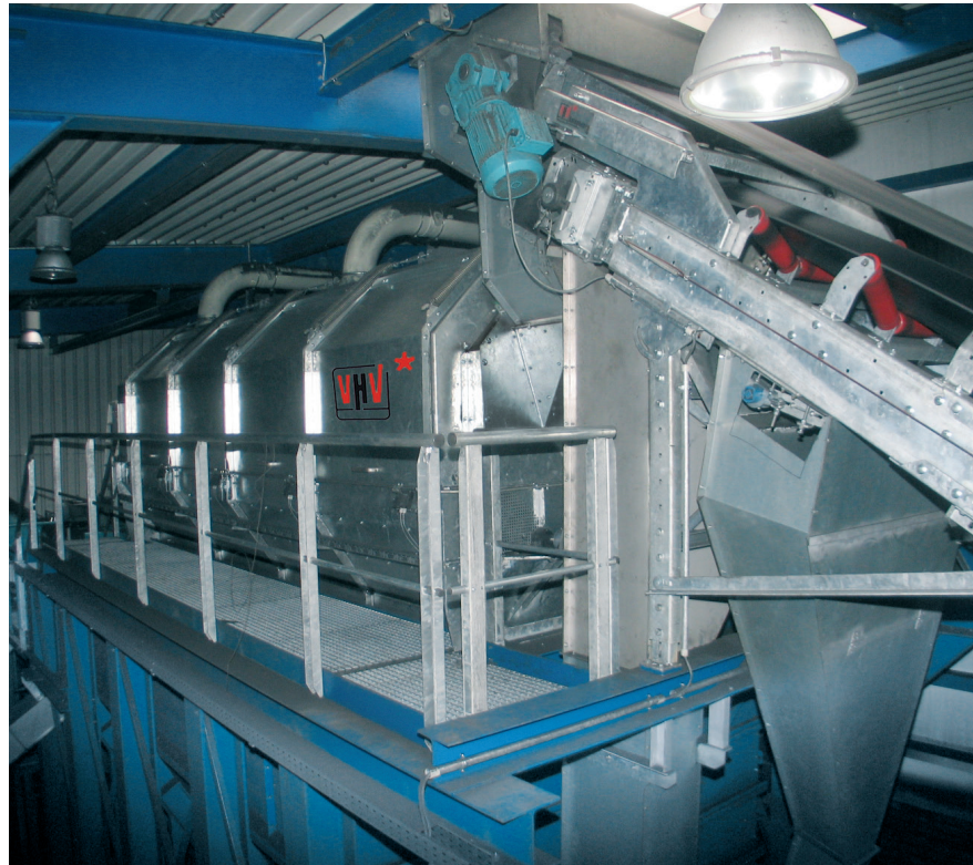
* ポリゴンスクリーン内の砂を電磁式磁気ドラムを介して、鉄や不純物の除去を行います
