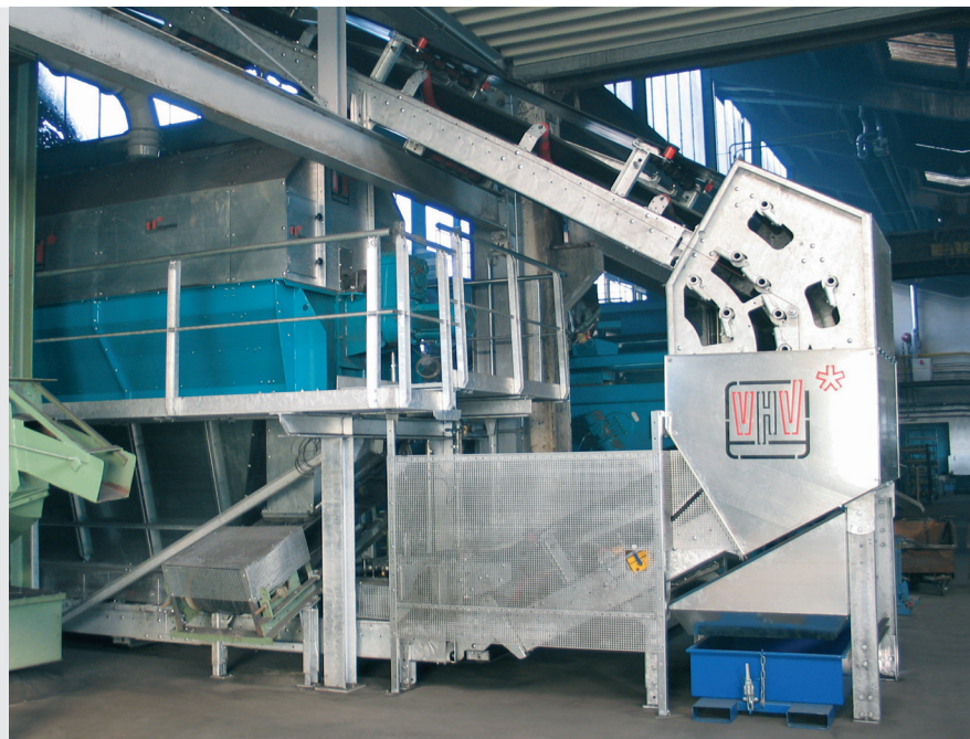
* 「VHVベルトコンベアとの組み合わせでフロア上でのポリゴンスクリーンの据付が可能です」
