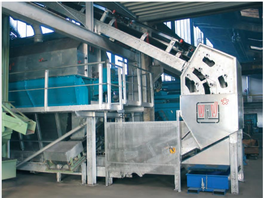
\* тяговая способность ленточных транспортёров VHV позволяет устанавливать грохоты также на нижних этажах или в подвалах
