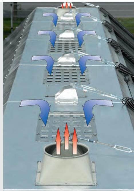
\* Вентиляционные отверстия для отсоса пыли и снижения температуры с регулируемыми приточными отверстиями
