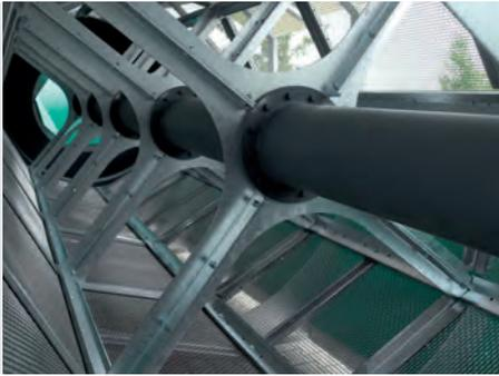
\* крутильно - жёсткий, наклонный корпус грохота (внутренний вид).
