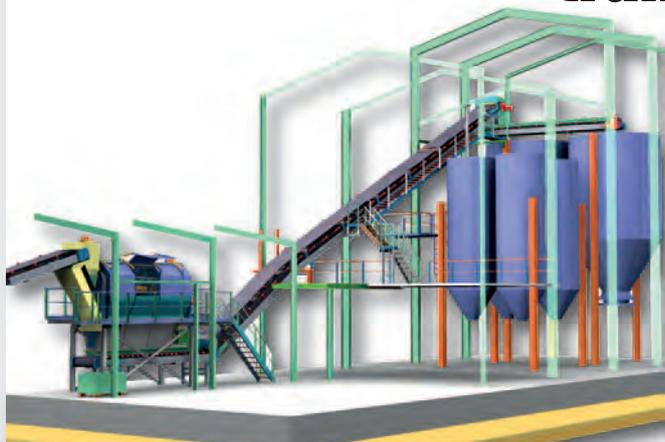
\* Cinta transportadora tipo sandwich desde el filtro poligonal hasta el silo.
