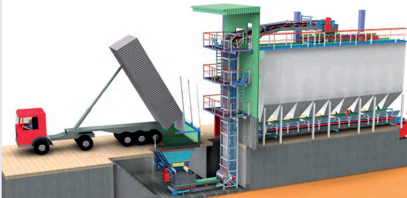
\* Carga del silo (solo con producto), con recepción para camiones, cinta transportadora doble, cinta practicable y reversible, así como dosificadores y cinta de pesaje.
