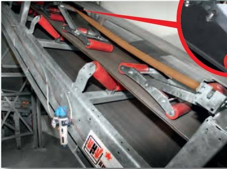
\* Los accionamientos portantes y de la cinta tipo sandwich cuentan con rascadores de segmento frontal y de torsión.
