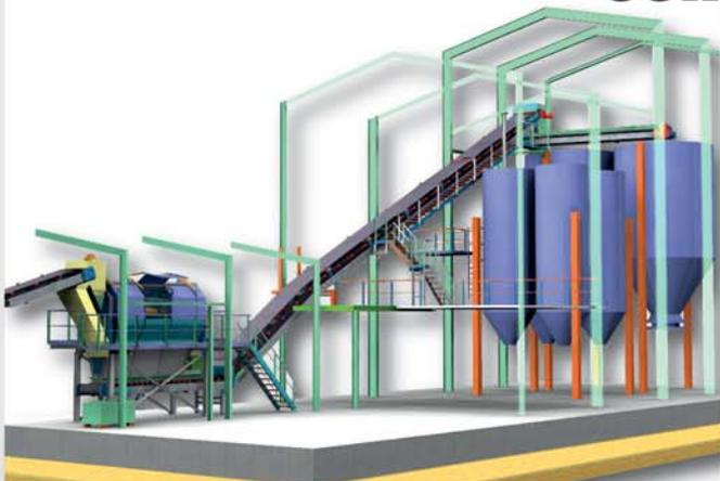
\* Convoyeur à bande de recouvrement entre tamis polygonal et silo
