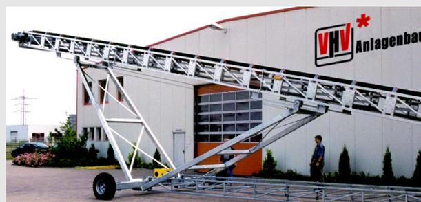
*ensemble roulant, pivotant et réglable en hauteur*
