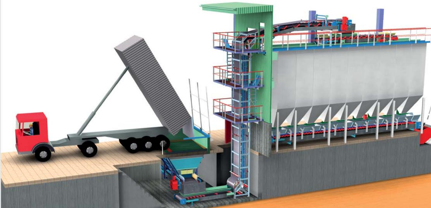
\* Sans pollution granulométrique alimentation de silos avec déchargement camion, double bande de transfert, tapis navette ainsi que tapis doseur et tapis peseur.
