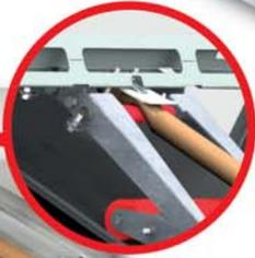
\* Bandes porteuse et de recouvrement avec racleur frontal et racleur de tension
